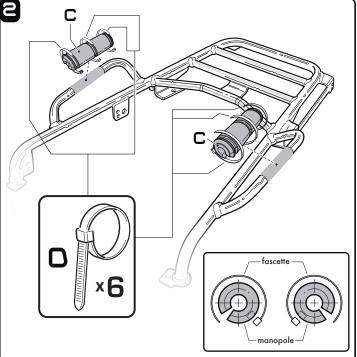
Dopodiché, adattare le due manopole C sopra alle strisce di grip, orientando il pundo di giunzione verso l'esterno del ponte bagagli come da figura. In questo modo si avranno gli incavi per l'alloggiamento delle asole di serraggio delle fascette verso l'interno. A questo punto applicare le fascette D sulle manopole in corrispondenza delle apposite nervature come da figura, mantenendo le asole di serraggio verso il basso; questo permetterà di nasconderle alla vista a montaggio ultimato.
